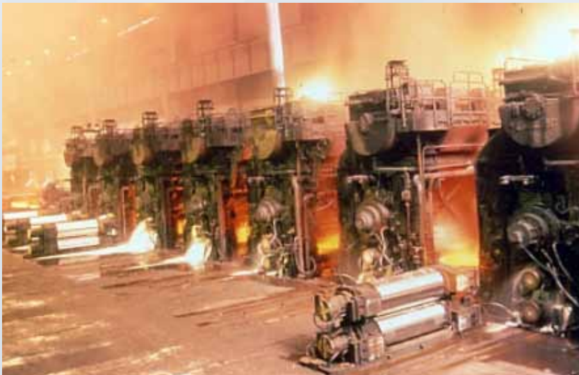
Photo issue d'une collaboration avec Arcelor-Mittal sur le contrôle du déport de bande dans un laminoin à chaud
